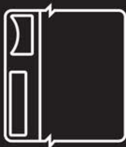
Detail otvoru pro střelku a závoru zámku
